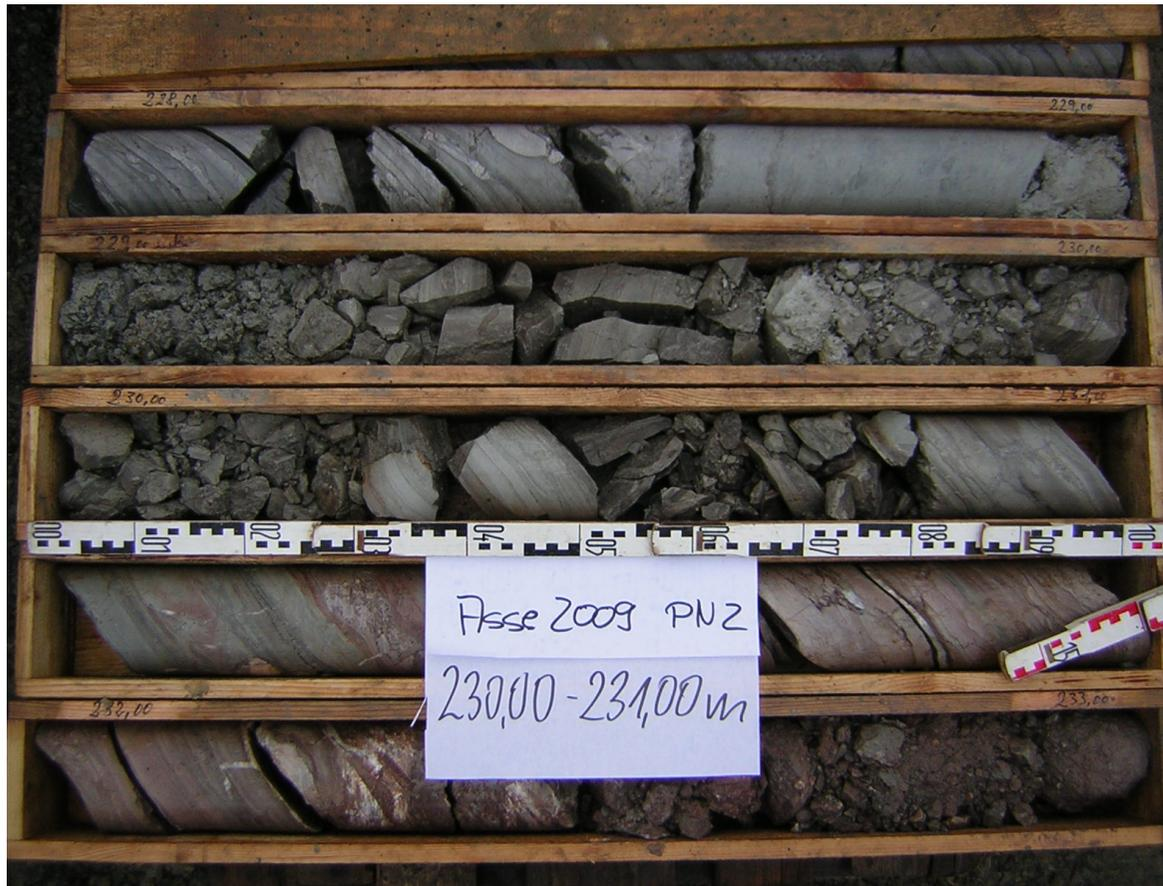
Wasserführende Störungszone, Bohrung PN2 (Unterkante Unterer Muschelkalk am Übergang zum Röt 4)
