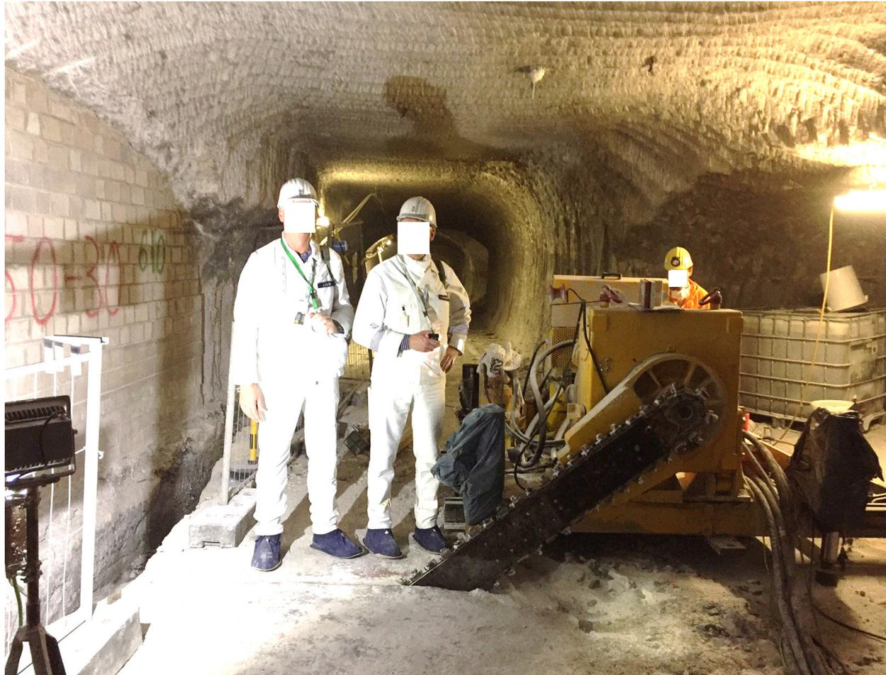
*Abbildung 2: östl. Zugangsbereich, Sicherheitsbefahrung und Zustandsbeurteilung des Sägeblattes der Korfmann-Säge,
