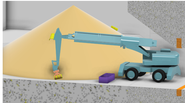
Abbildung 8: Prinzipdarstellung aus der Entwurfsplanung mit Bergegerät beim Greifen eines Gebindes
