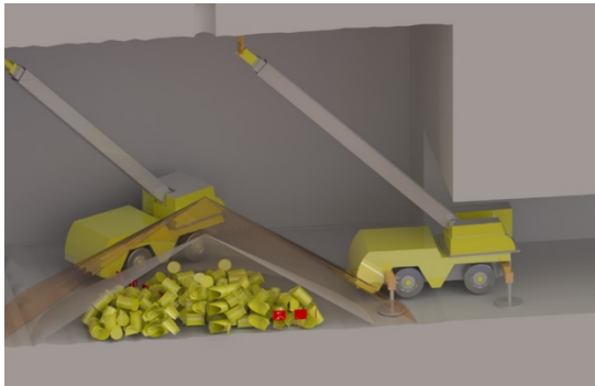
Abbildung 7: Prinzipskizze aus der Konzeptplanung mit Bergegeräten beim Sichern der Firste
