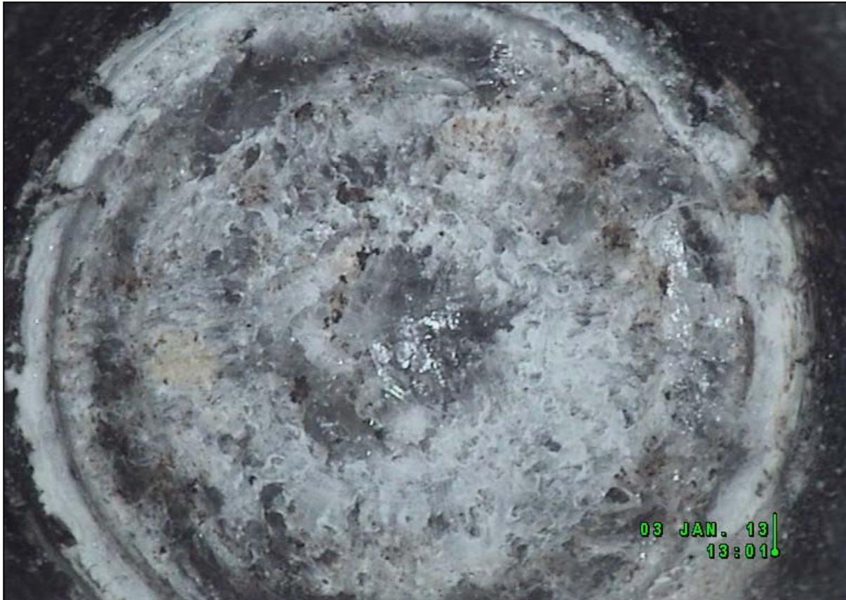
**Abbildung 14:** Steinsalzstruktur im Bohrloch Tiefsten bei einer Endteufe von 35 m
