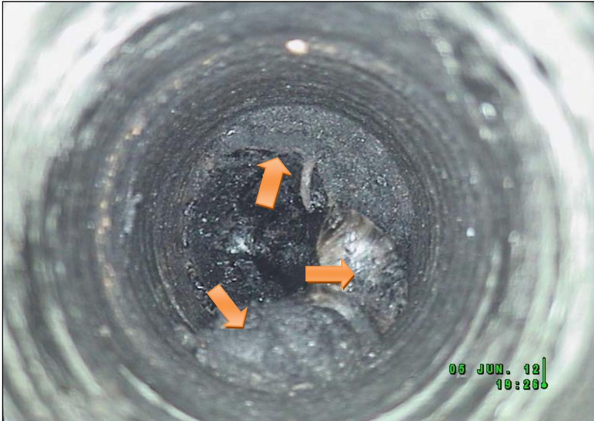
**Abbildung 12:** Verunreinigungen im Bohrloch (orangene Pfeile) in einer Teufe von 6,5 m
