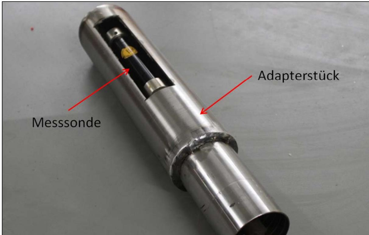
**Abbildung 19:** Im Adapterstück montierte Messsonde zur Bestimmung der Ortsdosisleistung im Bohrloch
