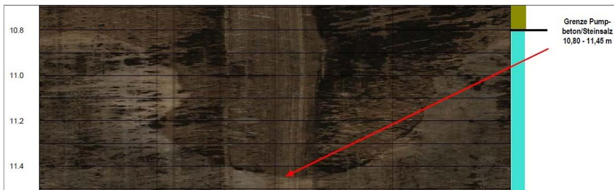
**Abbildung 15:** Auszug aus dem Bohrlochscan (10,80 m bis 11,45 m), Übergang Pumpbeton/Steinsalz
