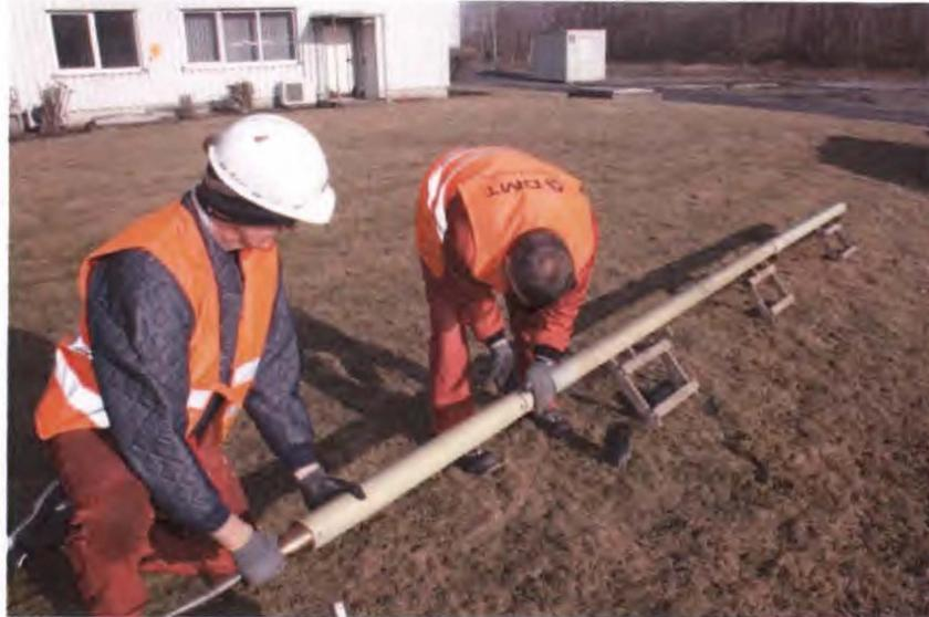
Darstellung 2: Zusammengebaute richtungssensitive 3D-Bohrlochradarsonde Modell 85.
