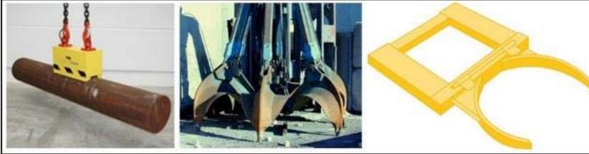
Abbildung 11: Werkzeuge zum Greifen, Heben und Laden der Gebinde (links: Magnetheber, Quelle: [www.pixabay.com](http://www.pixabay.com), mitte: Polypgreifer, Quelle: [www.pixabay.com](http://www.pixabay.com), rechts: Fassklammer)
