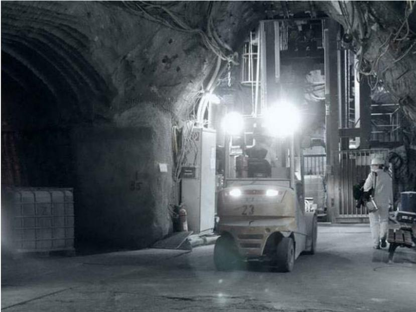
Abbildung 36: Beschickung des Förderkorbs mittels Stapler im Füllort 750-m-Sohle der Schachtanlage Asse II
