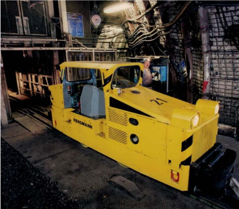
Abbildung 35: Gleisverkehr mittels Lokomotiven (Quelle: Rennsmann)
