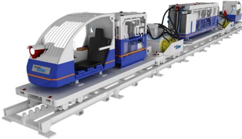
Abbildung 38: Kettengeriebene Schienenflurbahn (Quelle: Becker Mining Europe GmbH)
