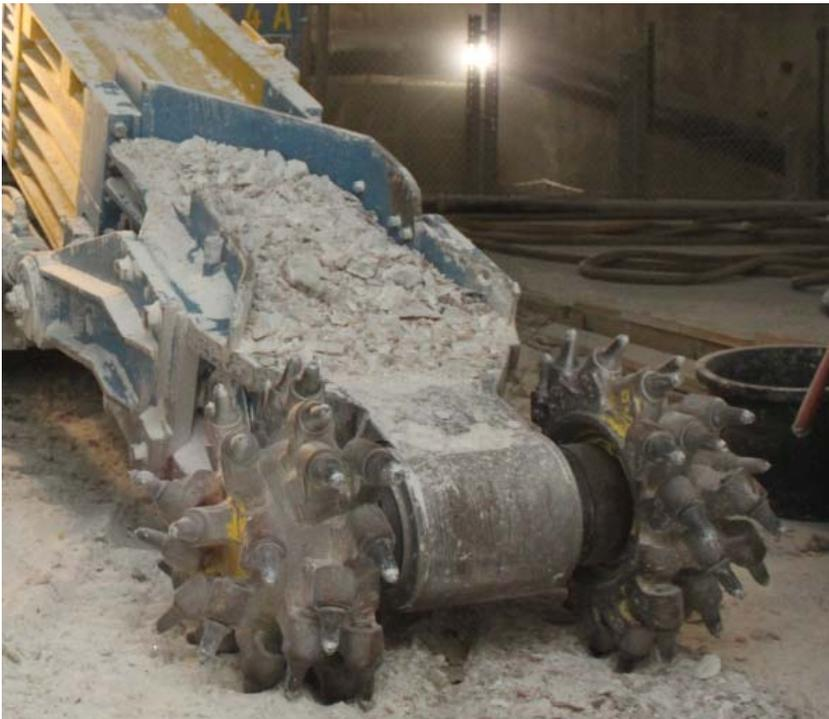
Abbildung 6: Fräskopf zum Bereißen/Nachschneiden der Hohlraumkontur (Aufgenommen auf der Schachtanlage Asse II)
