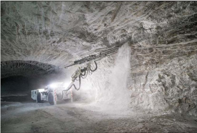
Abbildung 7: Ankerbohrwagen (Quelle: GHH Fahrzeuge GmbH)
