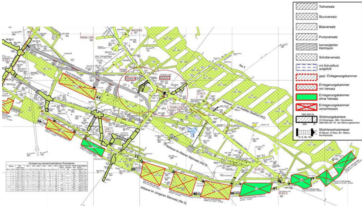
Abb. 11: Ausschnitt des Sohlenrisses der 750-m-Sohle (Stand 2019); farbliche Sohlenkennzeichnung gemäß Risswerk; grau = geneigte Strecken, hellgrün = horizontale Strecken/Kammern der 750-m-Sohle, Schraffur = Verfüllung (nach [19])
