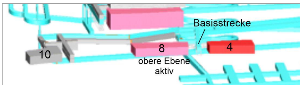
Abb. 39: Verfüllung eines Teils der westlichen Vorrichtungsstrecken während der Rückholung aus ELK 8/750 (vordere rosa ELK) im Rückholbereich Süd
