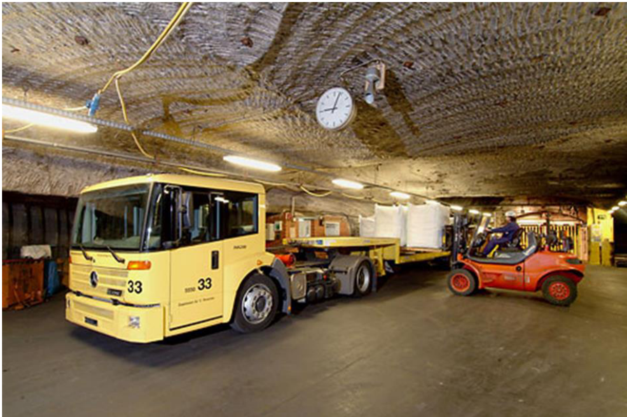
Abb. 168: Pritschenfahrzeug während Beladevorgang im untertägigen Deponiebetrieb
