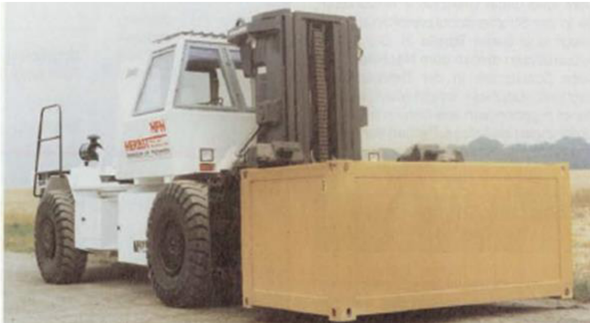
Abb. 101: Beispielhaftes Staplerfahrzeug für Horizontaltransporte der Umverpackungen (Endlager Konrad)
