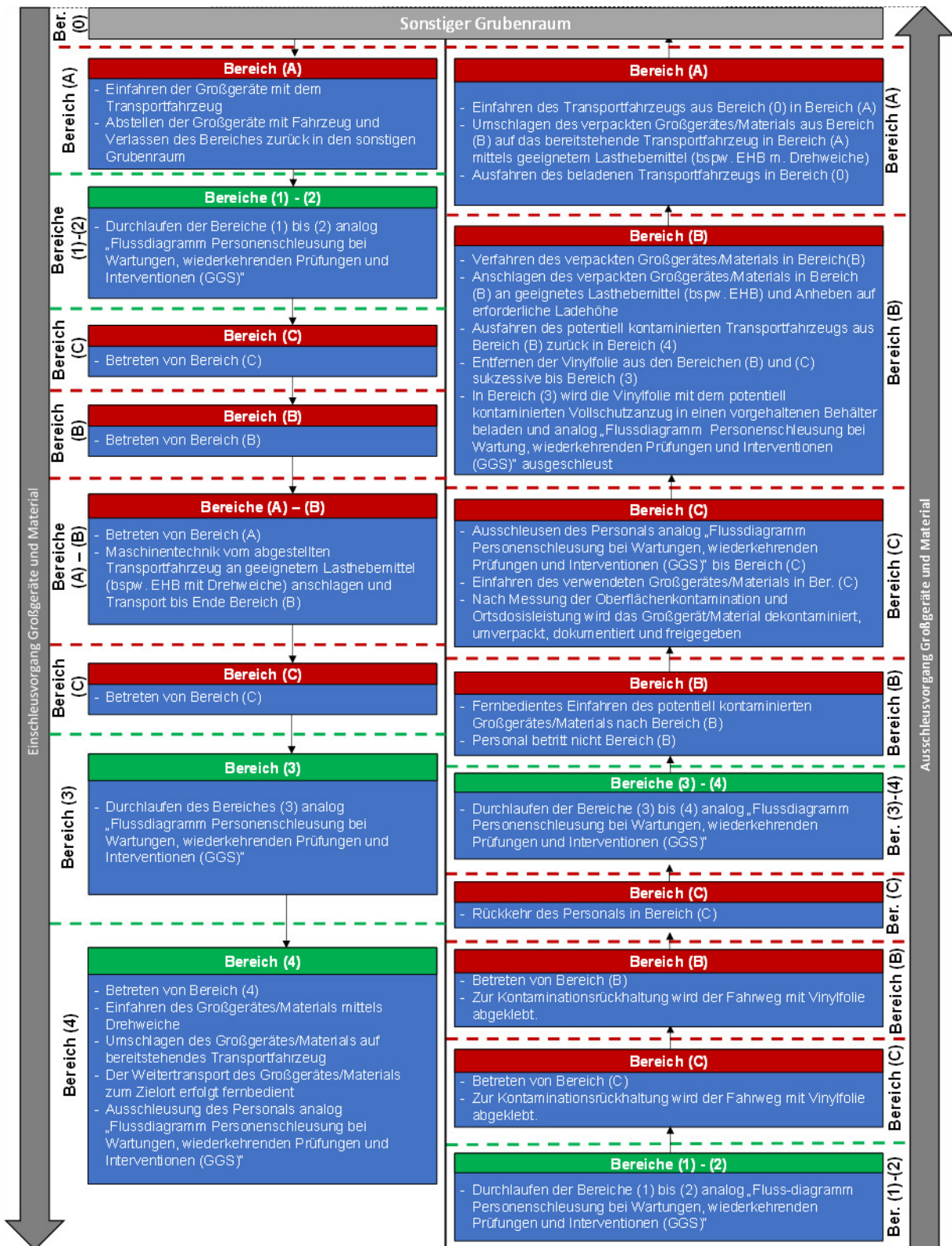
Abb. 100: Flussdiagramm Ein- und Ausschleusen von Material und Großgeräten
