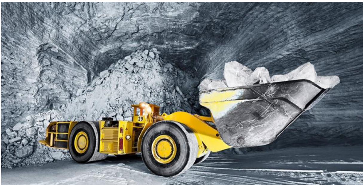
Abb. 166: Untertage Radlader mit Schaufel aus dem Salzbergbau
