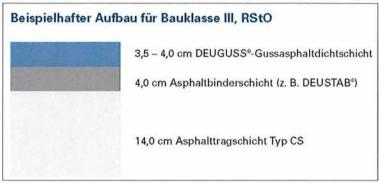
Abbildung 9: Beispiel Aufbau für Bauklasse III, RStO
