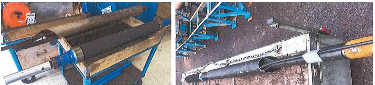
Abbildung 3: Dilatometer-Sonde mit Schlammrohr. Links: in Werkstatt; Rechts: vor Einbau in R18
