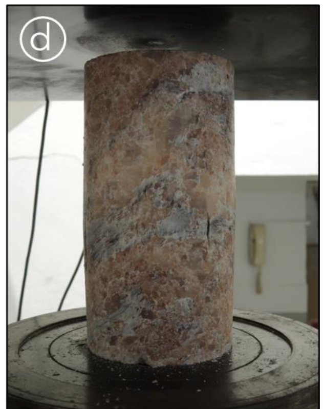
Abbildung 42: Proben aus dem Deckgebirge (a, b) und dem Salinar (c, d) sowohl vor (a, c) als auch nach (b, d) dem Einaxialen Druckversuch
