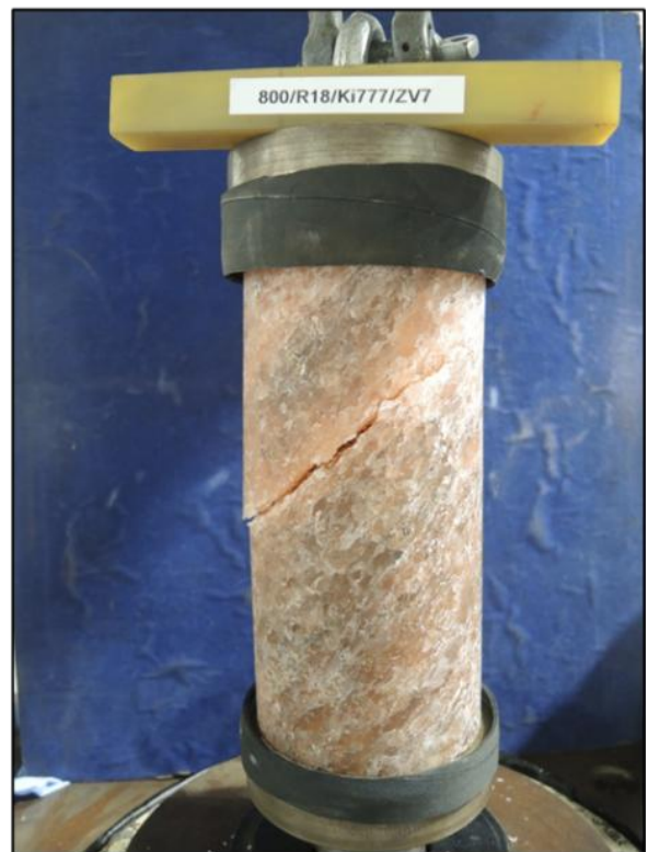
Abbildung 5: Versuchsaufbau für den direkten Zugversuch der Probe vor Versuchsbeginn (a) und nach Beendigung des Versuches (b).
