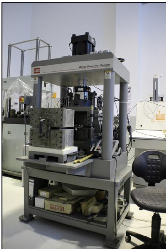
Abbildung 6: (a) Prüfapparatur MTS 816. (b) Eingebaute Probe vor Beginn des indirekten Zugversuchs (Spaltzugversuch).
