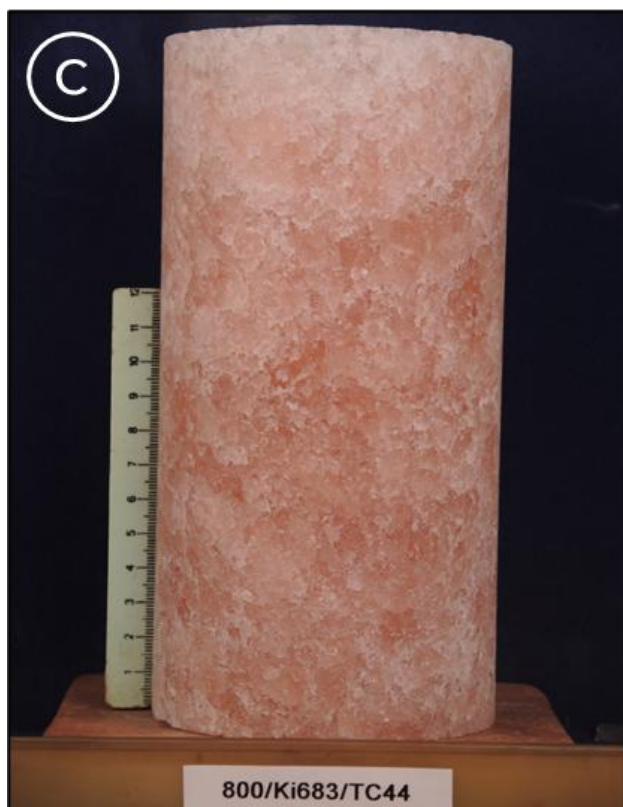
Abbildung 44: Proben aus dem Deckgebirge (a, b) und dem Salinar (c, d) sowohl vor (a, c) als auch nach (b, d) dem Triaxialen Druckversuch
