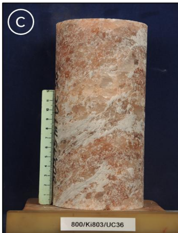
Abbildung 42: Proben aus dem Deckgebirge (a, b) und dem Salinar (c, d) sowohl vor (a, c) als auch nach (b, d) dem Einaxialen Druckversuch
