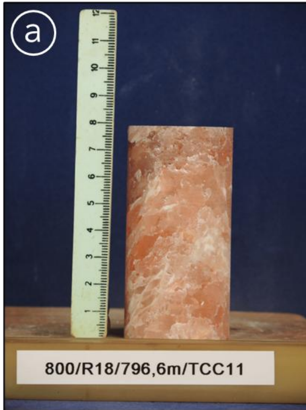
Abbildung 51: Probe aus dem Salinar sowohl vor (a) als auch nach (b) dem Dreiaxialen (Druck-) Kriechversuch
