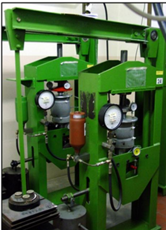
Abbildung 7: (a) Hebel-Kriechprüfapparaturen (Dauerstandsgeräte), (b) Schematische Darstellung einer eingesetzten Apparatur mit Druckkammer zur Realisierung von "quasi"-in situ Bedingungen.
