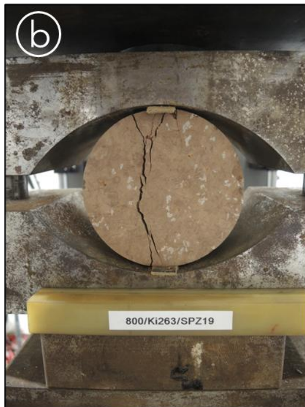
Abbildung 49: Probe aus dem Deckgebirge sowohl vor (a) als auch nach (b) dem Spaltzugversuch (Indirekter Zugversuch)
