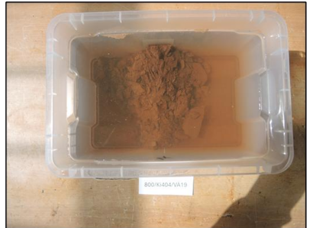
Abbildung 9: (a) Probenmaterial bevor und (b) nach der Bestimmung der Veränderlichkeit.
