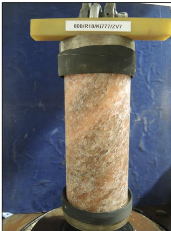
Abbildung 5: Versuchsaufbau für den direkten Zugversuch der Probe vor Versuchsbeginn (a) und nach Beendigung des Versuches (b).
