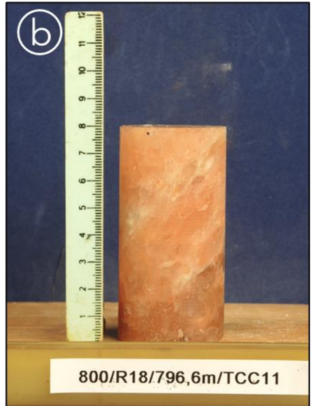
Abbildung 51: Probe aus dem Salinar sowohl vor (a) als auch nach (b) dem Dreiaxialen (Druck-) Kriechversuch
