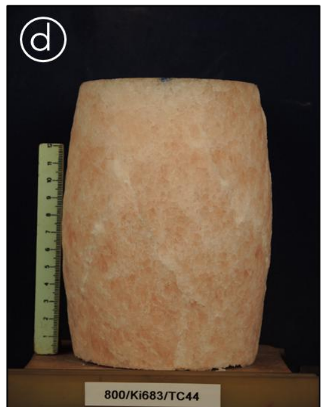
Abbildung 44: Proben aus dem Deckgebirge (a, b) und dem Salinar (c, d) sowohl vor (a, c) als auch nach (b, d) dem Triaxialen Druckversuch
