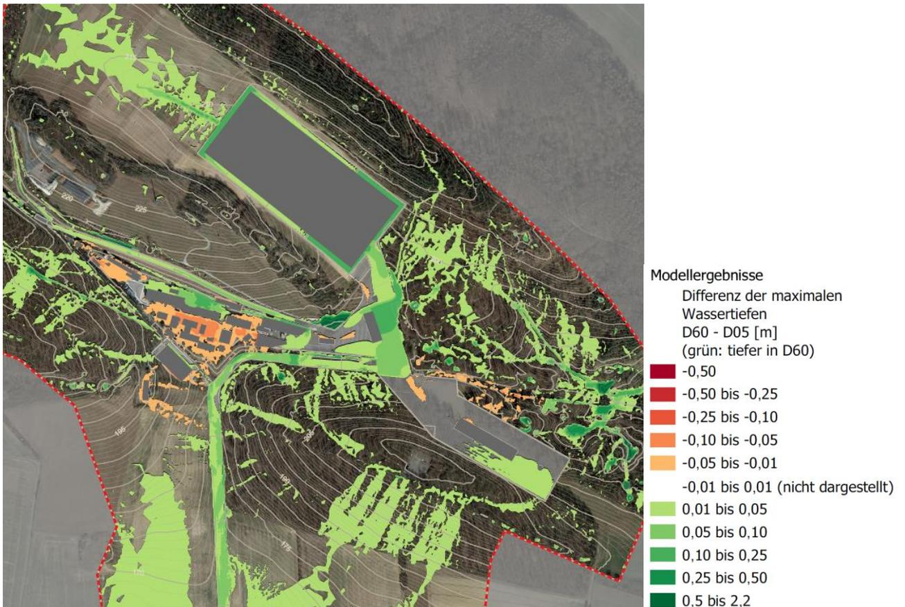
Abbildung 12: Differenz der Überflutungstiefen bei den Dauerstufen  $D = 5$  min und  $D = 60$  min ( $T_a = 1.000$  Jahre)
