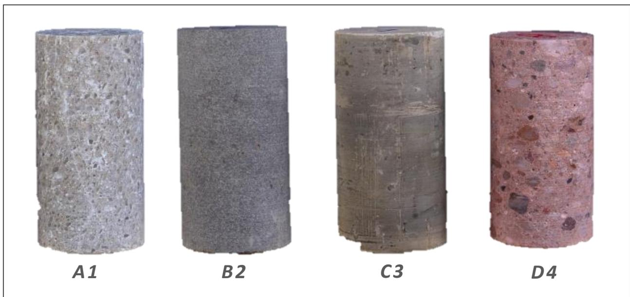
Abbildung 1: Prüfkörper der untersuchten Sorelbaustoffe A1, B2, C3 und D4
