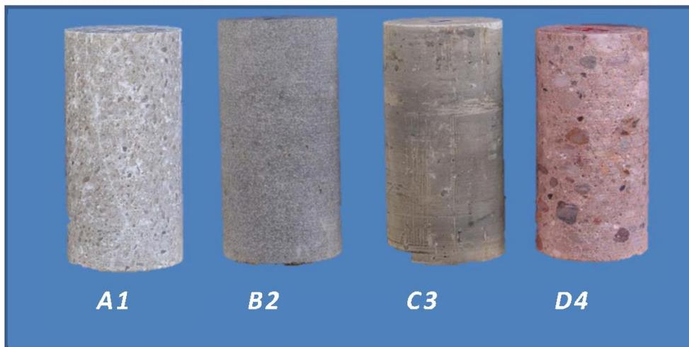
Abb. 3-1. Prüfkörper der zu untersuchenden Sorelbetonchargen.
