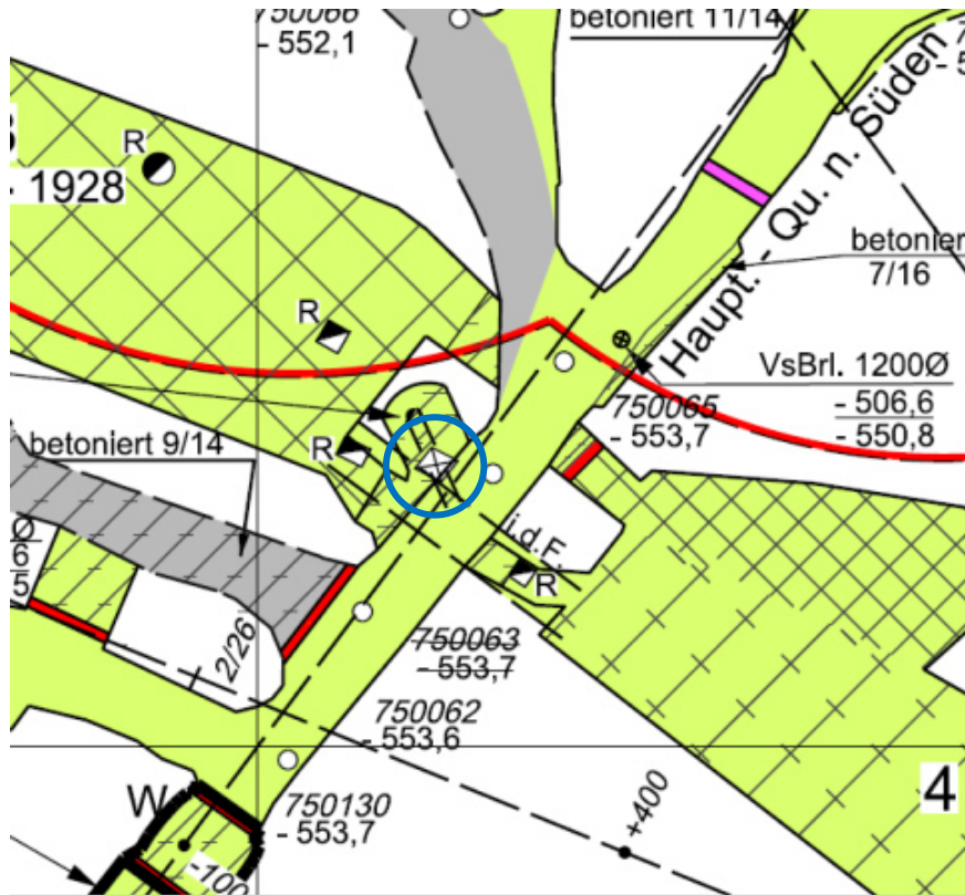
Abbildung 1: Fußpunkt des Rolllochs SVS-750-14 auf der 750-m-Sohle [Asse 2016a]
