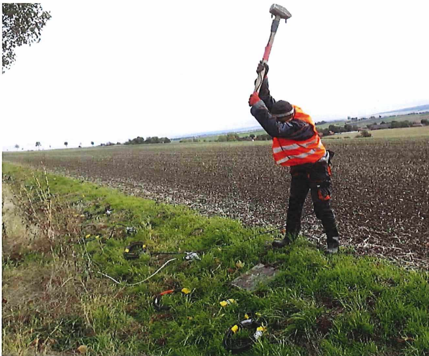
Abbildung 9: Nahlinienmessung mit Hammerschlag als seismischer Quelle.
