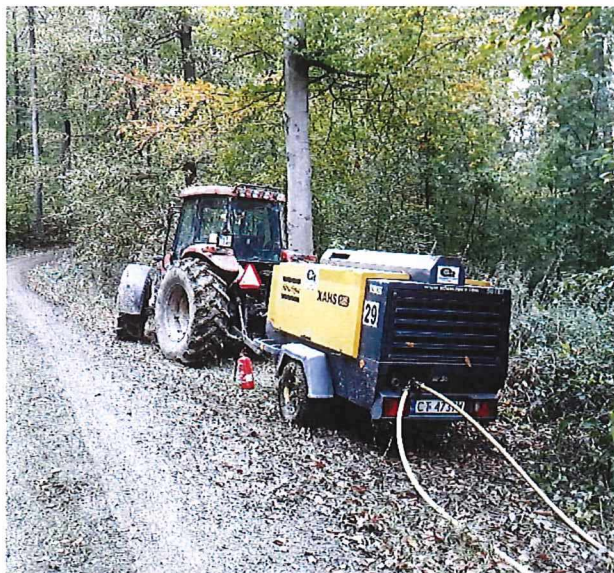
Abbildung 37: Kompressor Atlas Copco XAHS 186 zur Erzeugung von Druckluft für den Betrieb der Bohrgeräte.
