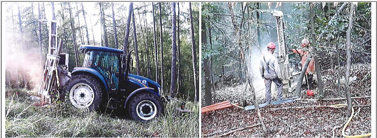
Abbildung 36: Auf einem Traktor montiertes Bohrgerät PAT 301 (links) und portables Bohrgerät EMCI Explor 220MPR (rechts).
