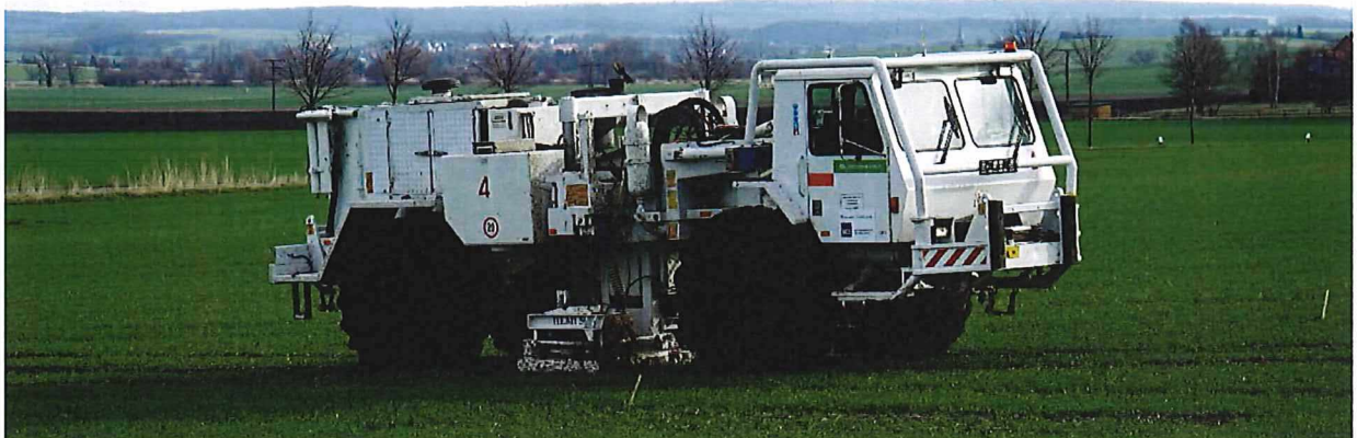
Abbildung 28: Vibrator vom Typ Hemi 50 auf einem Trägerfahrzeug Mark IV.
