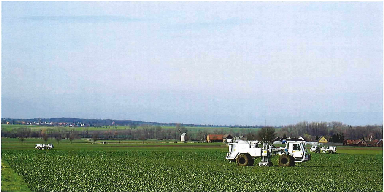
Abbildung 30: Mehrere Vibratoren im Slip-Sweep-Verfahren im Einsatz auf Feldern bei Dettum.
