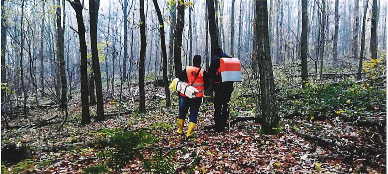
Abbildung 6: Vermessung von Empfangspunkten mit dem inertialen Navigationssystem ZUPT B-PINS (grau/orangener Tornister) im Asse-Wald.
