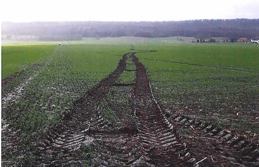
Abbildung 17: Fahrspuren eines Vibrofahrzeugs mit Abdrücken der Bodenplatte entlang einer Anregungslinie. Im Hintergrund ist das Umfahren einer Kampfmittelverdachtsfläche zu erkennen.
