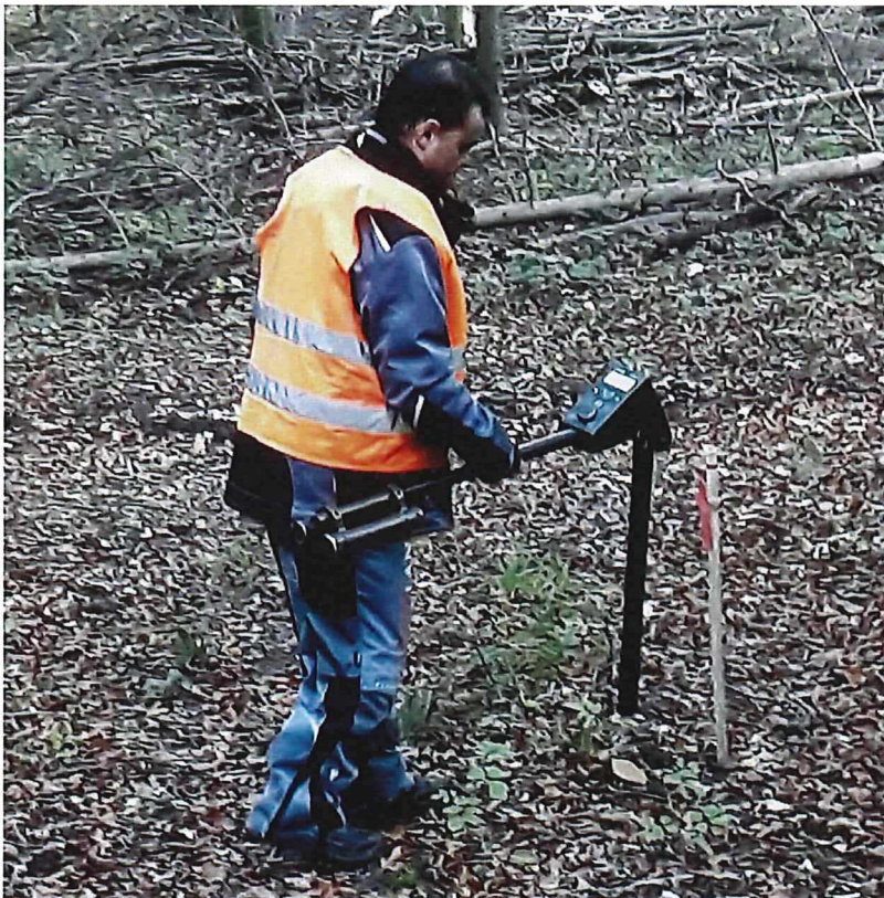
Abbildung 8: Untersuchung der Bohransatzpunkte auf Kampfmittelaltlasten mit einem Magnetometer Sensys SBL10.
