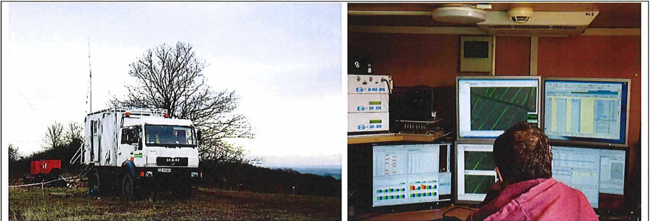
Abbildung 32: Messwagen (links) von dem aus die Signalsteuerung der Vibratoren und deren technische Kontrolle erfolgte (rechts).
