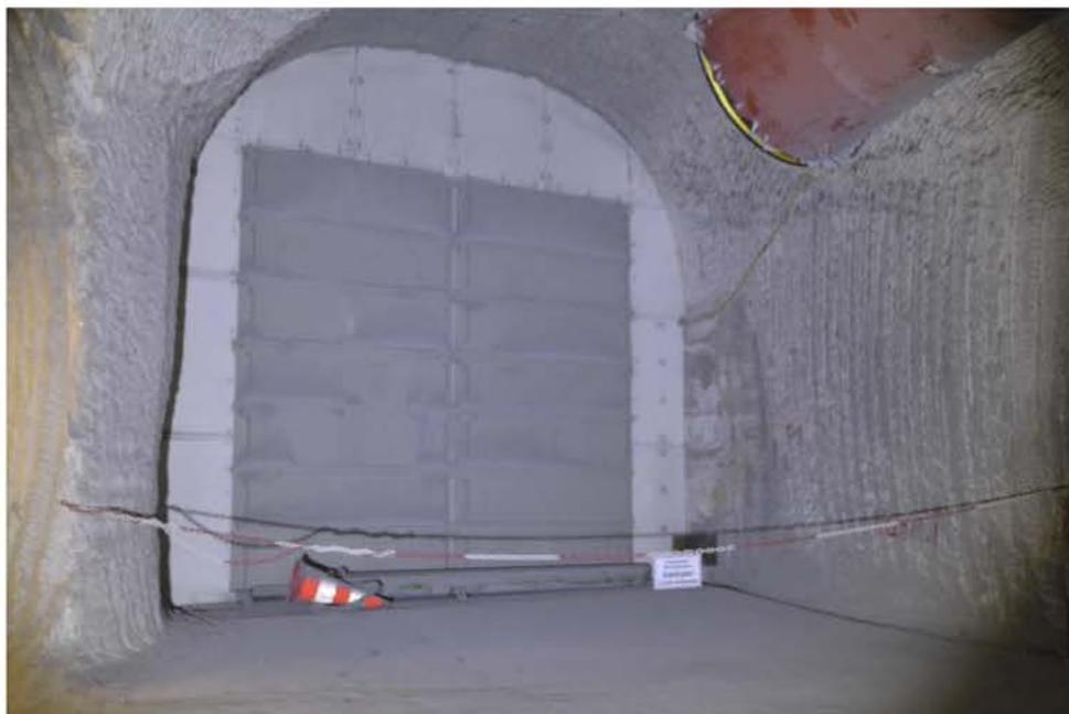
Abbildung 11.1: Fotoaufnahme der Schallschutzkulissee des Hauptgrubenlüfterstandortes auf der 490-m-Sohle vom 03.01.2017.
