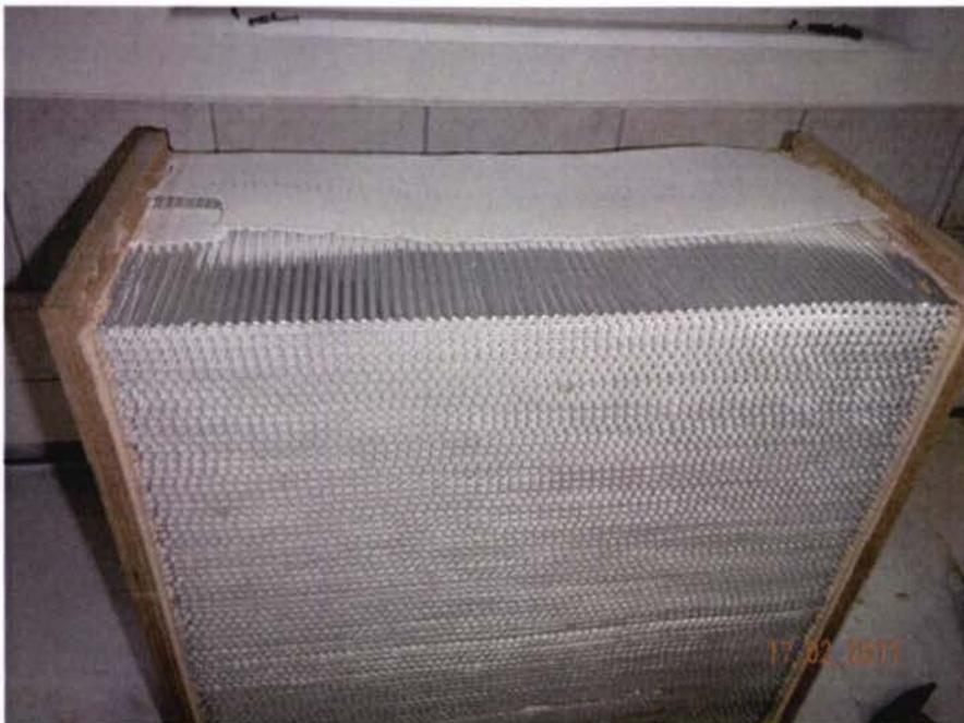
Abbildung 5: Filterelement mit abgenommenem Seitenteil, oberste Lage
