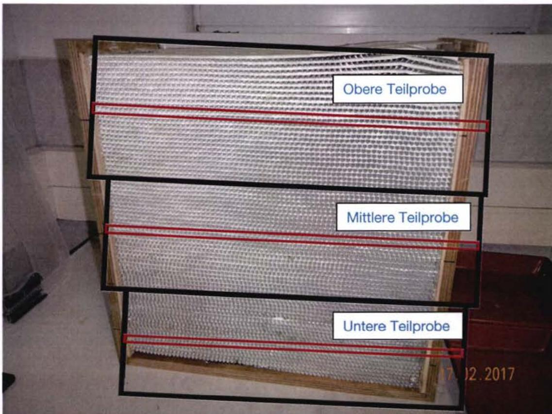
Abbildung 9: Zur Entnahme von Teilproben wurde der Filter in drei Bereiche von je 48 Lagen unterteilt. In schwarz sind die entsprechenden Bereiche eingezeichnet. Diese wurden aus dem Filterelement ausgeschnitten. Aus der Mitte des separierten Bereiches wurde jeweils eine Teilprobe für die Analyse entnommen. Die Größe der Teilprobe richtet sich u.a. nach der Aktivität auf dem Filtermaterial. Der Rest des Bereiches wird als Rückstellmuster aufbewahrt.
