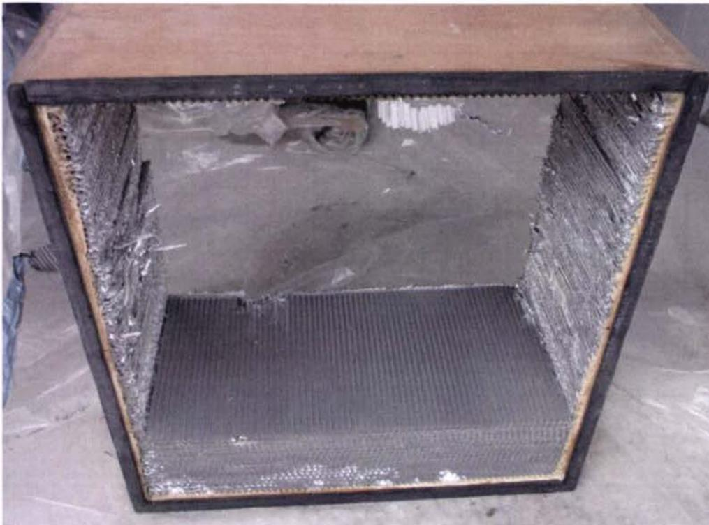
Abbildung 15: Hauptfilter nach der Probenahme
