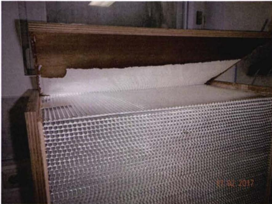
Abbildung 4: Das Filterelement wurde um 90° gedreht. Anschließend wurde das Seitenteil angehoben. Die Stützelemente und das darum gewickelte Filtermaterial werden deutlich sichtbar.
