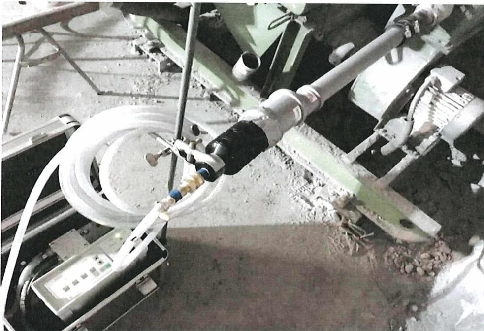
Abbildung 4: Messort 2: Abluftfilteranlage der MAW-Einlagerungskammer, Entnahme des Luftstromes auf der Reinfluftseite der Abluftfilteranlage, Bild unten: Detailaufnahme des verbauten Filtereinsatzes
