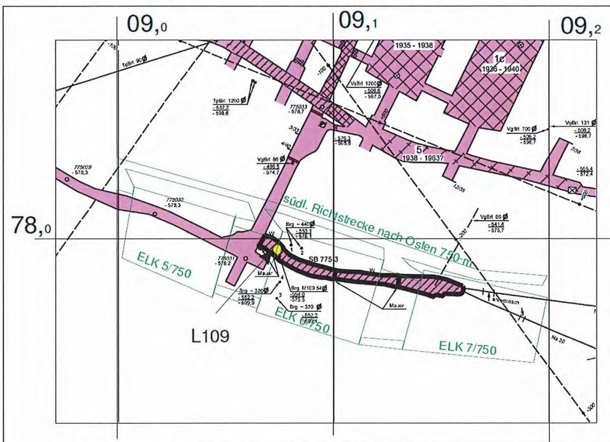
Abbildung 7.3-4: Messstelle L775004, Bohrung verpresst
