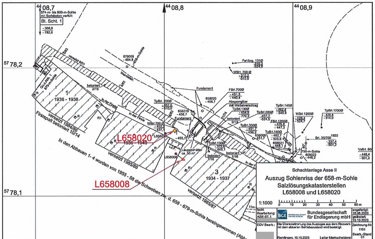
Abbildung 9.2-1: Lage der Probeentnahmestellen auf der 658-m-Sohle
