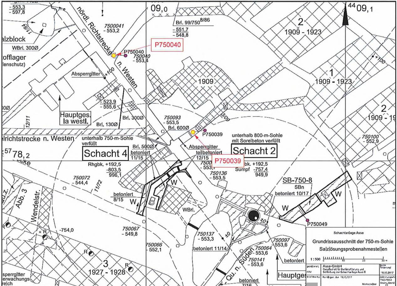
Abbildung 9.6-1: Lage der Probeentnahmestellen im Bereich des Kaliabbaufeldes der 750-m-Sohle
