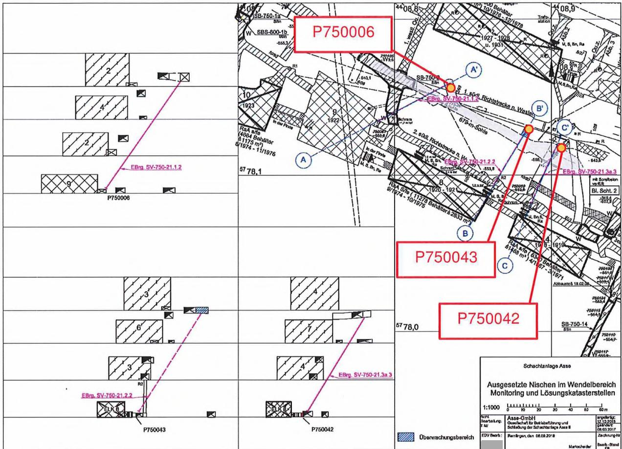
Abbildung 9.3-1: Lage der Hebestellen auf der 679-m-Sohle für die Probeentnahmestellen P750006, P750042 und P750043
