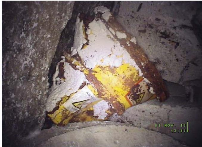
Im Jahr 2017 bohrte ein Team der Schachtanlage Asse II eine der alten Einlagerungskammern an und ließ eine Kamera herab. Hier sieht man ein zerquetschtes Fass mit radioaktiven Abfällen in 750 Metern Tiefe. So oder so ähnlich werden viele der rund 126 000 Fässer aussehen. Weil das Salzbergwerk als Endlager ungeeignet ist, müssen sämtliche Abfälle zurückgeholt werden.
