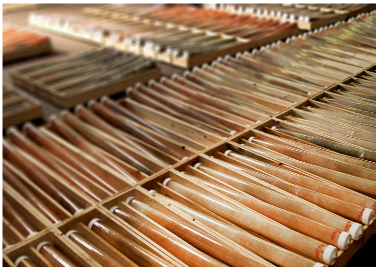
Die Bohrungen mit verschiedenen Bohrköpfen erreichten eine Tiefe von bis zu 900 Metern. Rund 5.600 Bohrkern hat die BGE über die Jahre gewonnen und untersucht.
