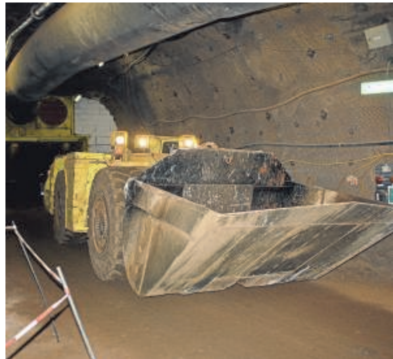
Riesige Schaufelradlader, die zwölf Tonnen Gestein transportieren, fahren unter Tage auf dem rund 40 Kilometer langen Wege-System. Fotos (6): Jörg Kleinert
