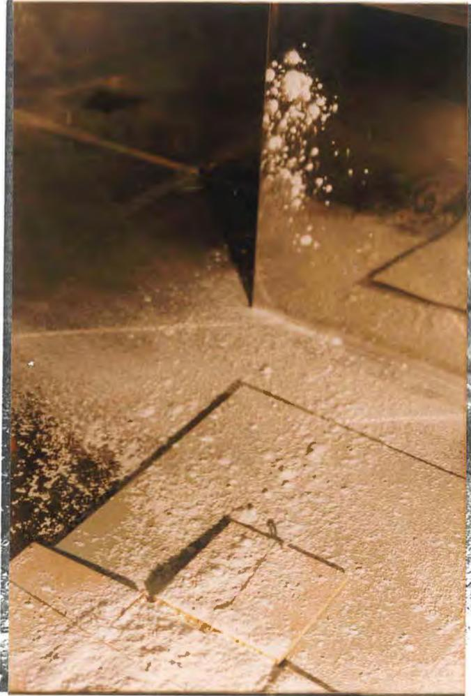
Bild 14: An die Kammerwand (quaderförmige Umhüllung des APS, siehe Bild 3) geschleuderte Pulvermasse
