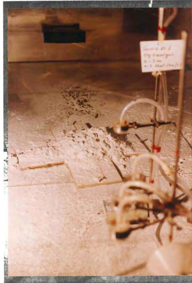
Bild 13: Versuch Nr. 7 (1 kg Kieselgur,  $h = 3$  m, mit Ventilation)
