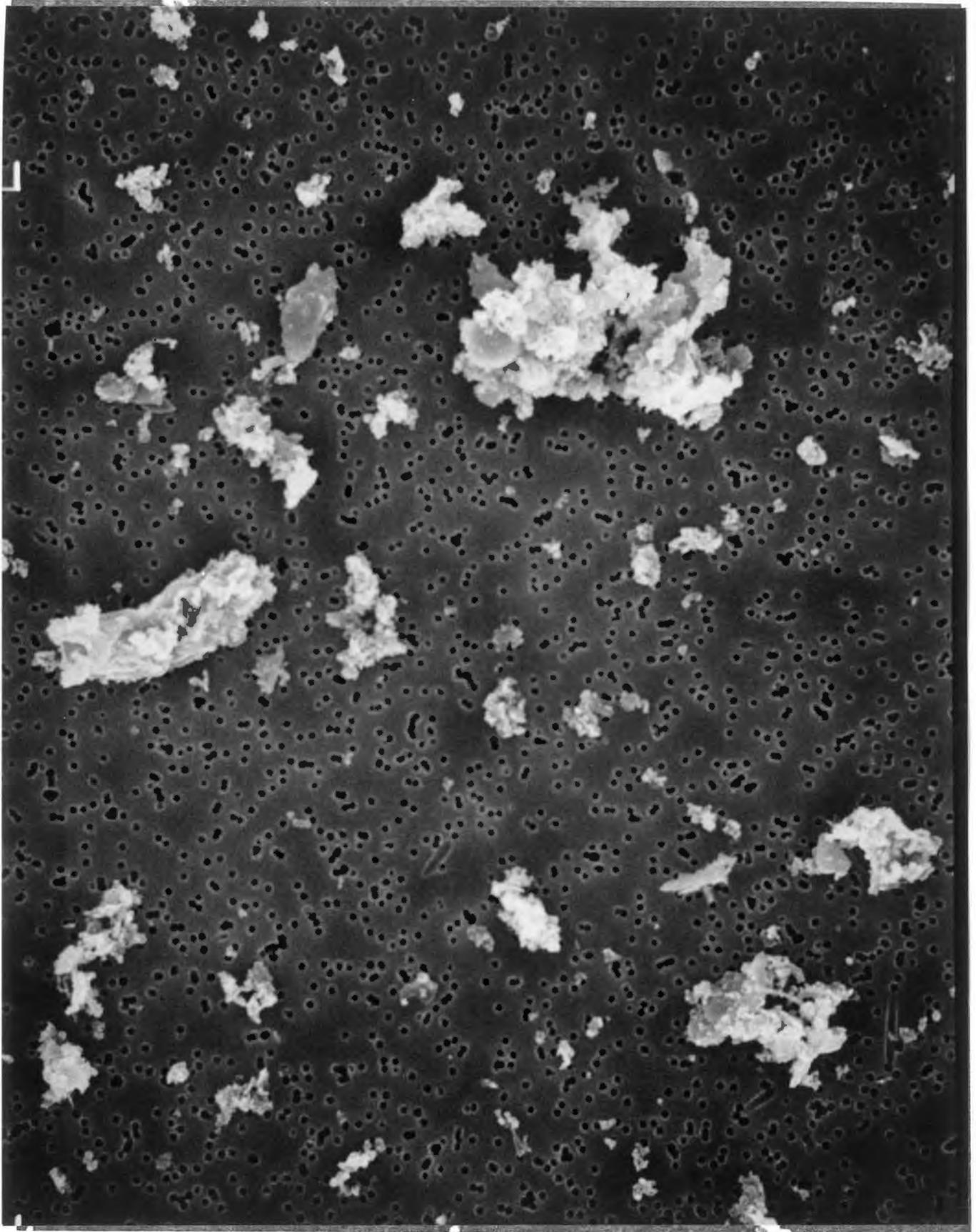
Bild 34: Elektronenmikroskopische Aufnahmen von in der Nähe der Kammerabsaugung auf Nucleoporefilter beaufschlagten Hausaschepartikeln. - Maßstab 1 cm = 5  $\mu$ m - Aufnahme 2 Minuten nach Aufprall, Probenahmedauer 3 s.
