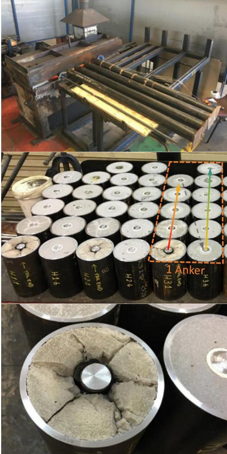
Abbildung 4-20: Ofen mit getesteten Klebeankern (oben); Proben für Push-Out-Versuch, die in Segmente á 150 mm gesägt wurden (mitte); wärmebeeinflusste Probe (unten), /7/
