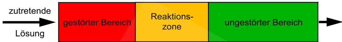
**Abb. 7.14** Schematische Darstellung eines Modells mit einer Reaktionszone für die Beschreibung der Permeabilitätsänderung von Abdichtungen
