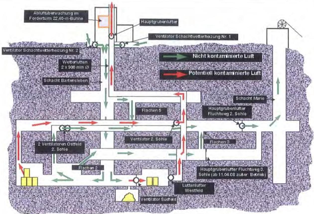
Abb. 2.1: Schematische Darstellung der Bewetterung der Einlagerungsbereiche
