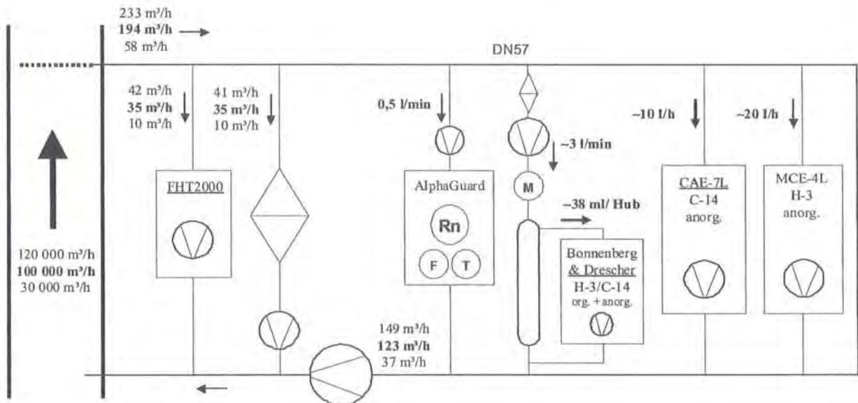
Abb. 2.2: Schematische Darstellung der Abluftprobenahme und-messung (Messstelle 1 Schacht Bartensleben)
