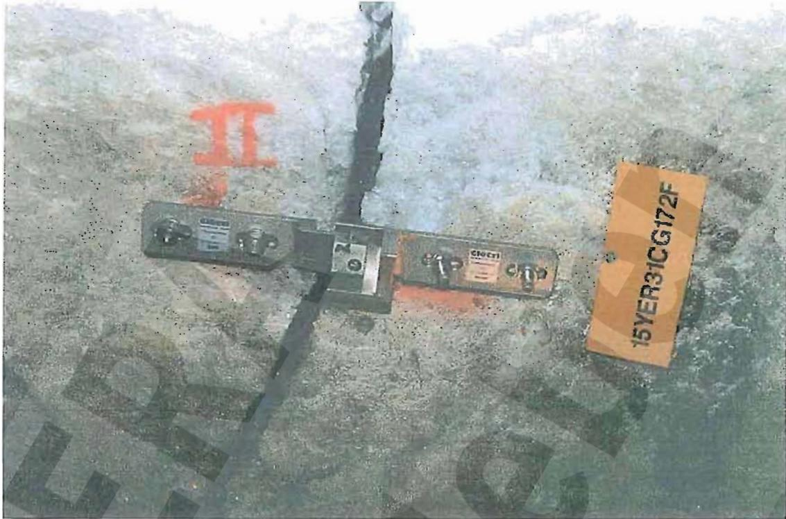
Bild 2: Fissurometer an der Firste des Durchhiebs zum Abbau 8s der -332 mNN Sohle
