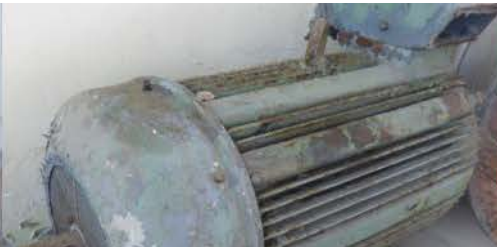
Reservemotor alter Hauptgrubenlüfter
