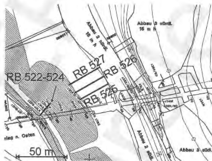
Abbildung 1: Ostquerschlag 2. Sohle, Lage der Bohrungen RB 522 - RB 527 1
