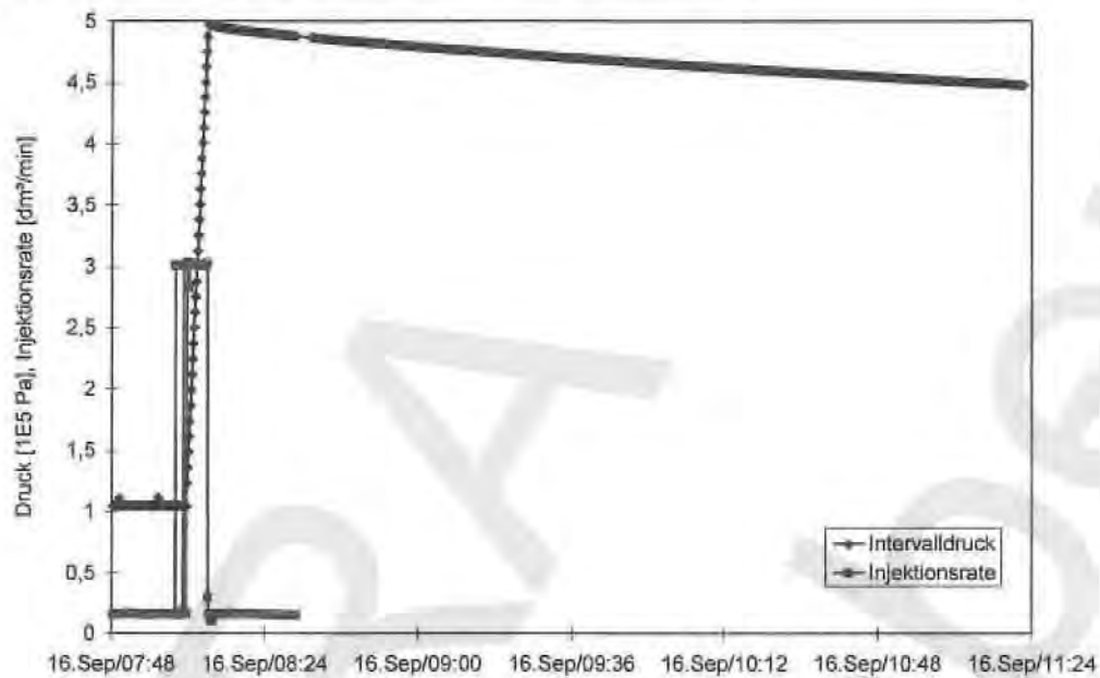
Abbildung 9: Verlauf von Injektionsrate und Druck in einem Pulstest
