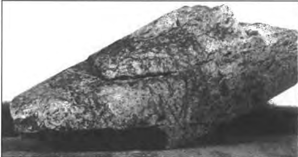
Abbildung 41: Beispiel für mit Carnallit belegte offene Kluft, Bohrung RB 530, Länge der unteren Bildkante entspricht ca. 20 cm
