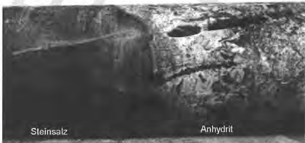
Abbildung 40: Kluft am Übergang Steinsalz (Kluft geschlossen) / Anhydrit (Kluft offen), Bohrung RB 530, Länge der unteren Bildkante entspricht ca. 20 cm
