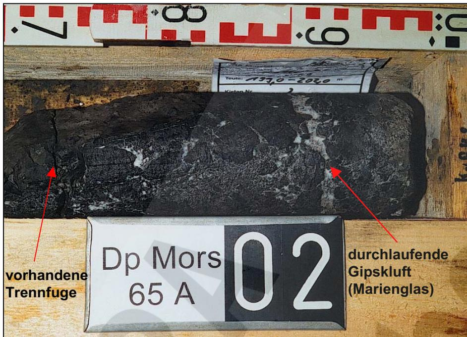
Abbildung 4: Kernabschnitt 200,7m bis 201,0m der Bohrung Dp Mors 65 (z3LK), Dolomitsteinbrekzie, Bruchstücke (Internschichtung) z. T. noch schichtig orientiert, zahlreiche kurze aussetzende Gipsklüfte, bei 200,9m durchgehende Kluff, Trennfläche (vermutlich d. Kerntrennung bei 200,7m)
