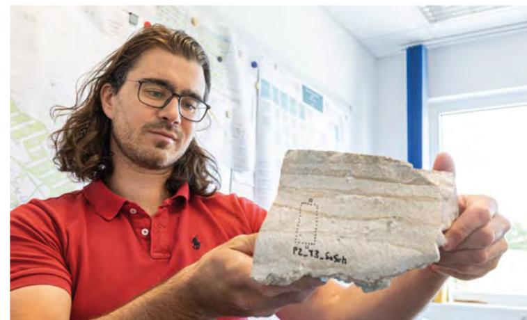
Ein weiteres Probestück in den Händen von Marcus Tresper. Es zeigt den lagenweisen Aufbau der einzelnen betonierten Chargen.
