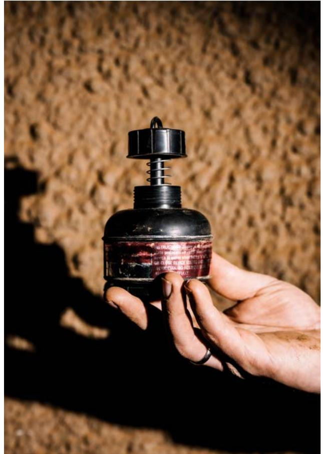
... befindet sich ein passives Radonmessgerät.
