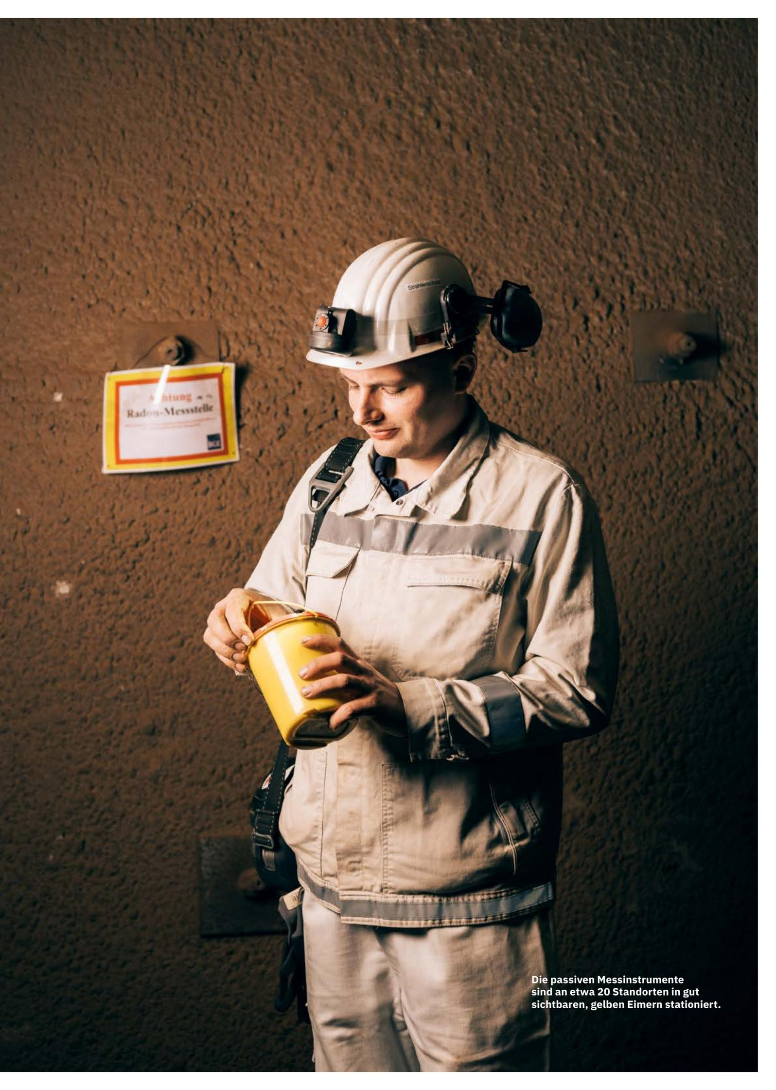
Die passiven Messinstrumente sind an etwa 20 Standorten in gut sichtbaren, gelben Eimern stationiert.
