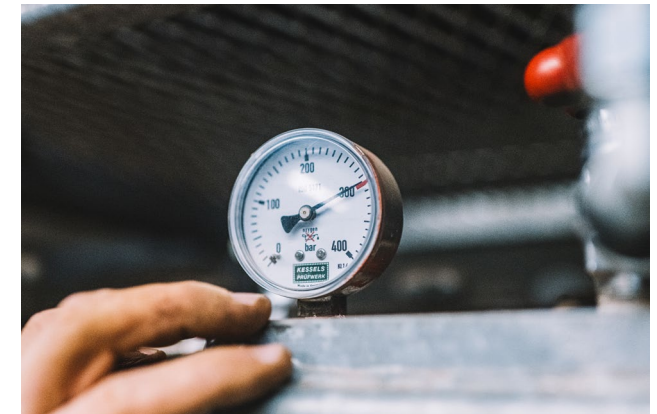
Schutzraum unter Tage, Schachtanlage Konrad. Manometer an einer Druckflasche, die mit komprimierter und atembare Luft gefüllt ist.
