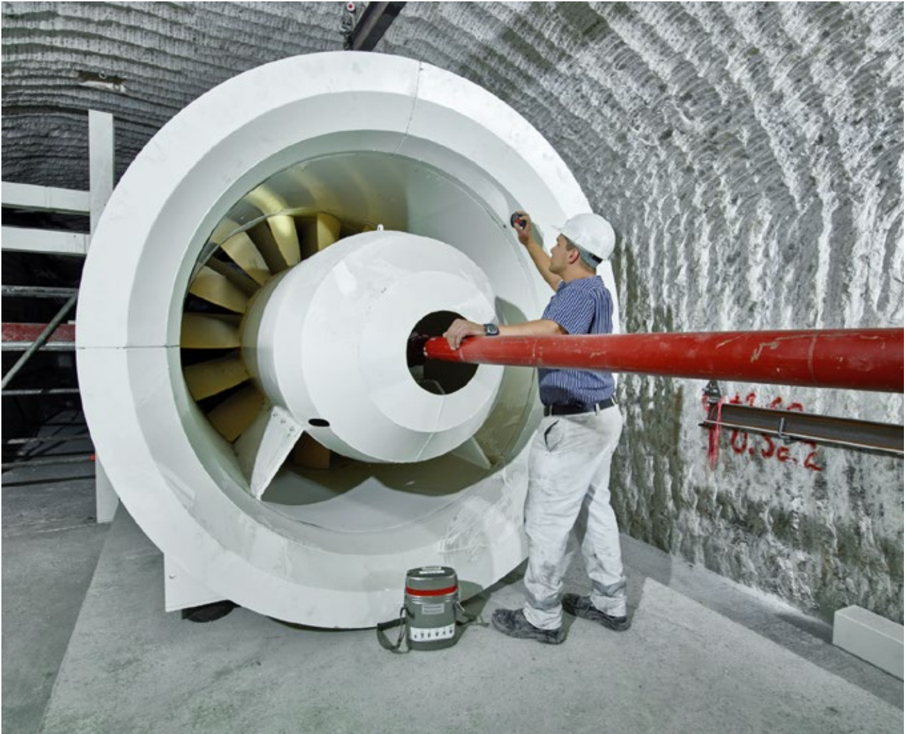
Die „Lunge“ der Schachanlage: Der Hauptgrubenlüfter auf der 490-Meter-Ebene garantiert den Austausch der Luft zwischen unter und über Tage
