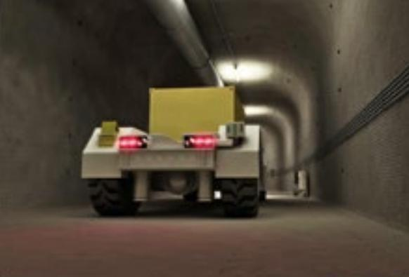
Unter Tage nimmt ein Hubwagen die Transporteinheit vom Plateauwagen ab und setzt sie auf einen Transportwagen um, der diese in den Eingangsbereich der entsprechenden Einlagerungskammer bringt.
