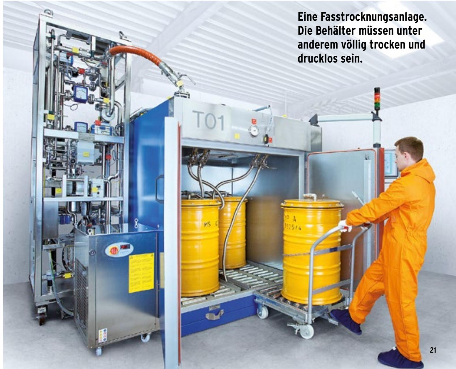
**Eine Fasstroycknungsanlage. Die Behälter müssen unter anderem völlig trocken und drucklos sein.**
