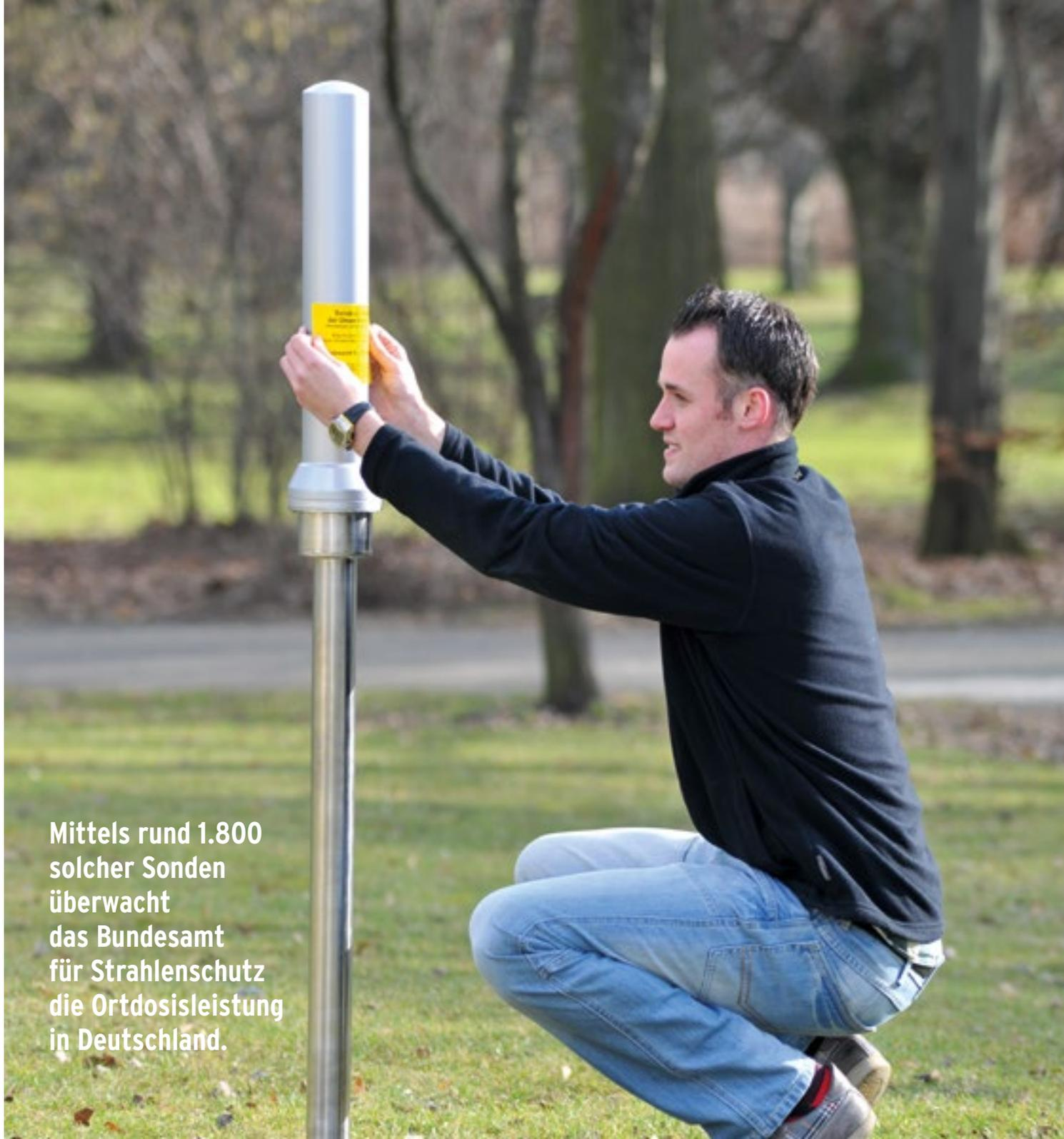
Mittels rund 1.800 solcher Sonden überwacht das Bundesamt für Strahlenschutz die Ortsdosisleistung in Deutschland.
