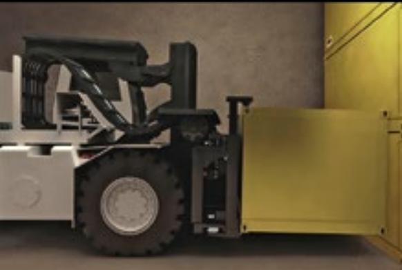
Hier wartet bereits ein Stapelfahrzeug, das die Abfallgebinde auf ihre Endposition in die Einlagerungskammer bringt. Die Einlagerungskammer wird von hinten nach vorne befüllt.
