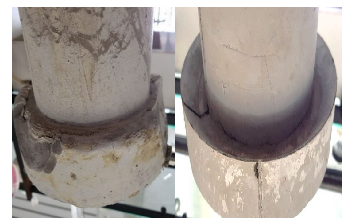
Abb. 4: Experimenteller Nachweis der Zementationsverbesserung in einer Probenkammer zur Simulation des offenen Bohrloches. Einpumpen der Zementschlämme ohne (Bild links) und mit (Bild rechts) Vibrationsenergie. Quelle: Pedrus et al. 2021
