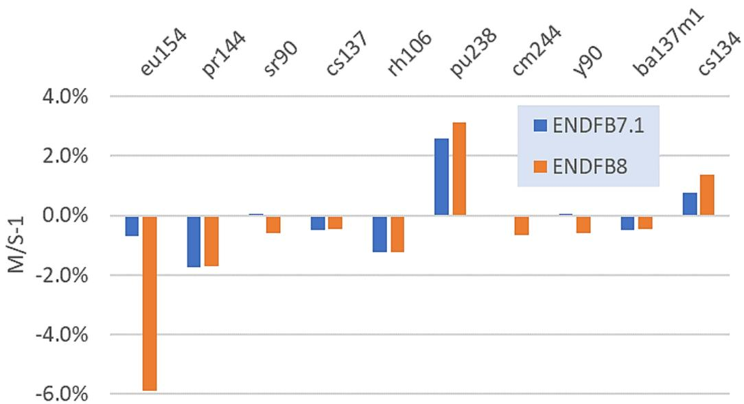
**Abbildung 2.9** DWR-Brennelement: relative Abweichung in den Konzentrationen zwischen den Rechnungen mit MOTIVE (M) und SCALE (S) für die wichtigsten Nuklide im Hinblick auf die Zerfallsleistung nach 5 Jahren Abklingzeit
