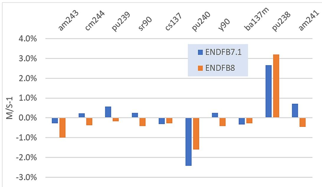
**Abbildung 2.10** DWR-Brennelement: relative Abweichung in den Konzentrationen zwischen den Rechnungen mit MOTIVE (M) und SCALE (S) für die wichtigsten Nuklide im Hinblick auf die Zerfallsleistung nach 100 Jahren Abklingzeit
