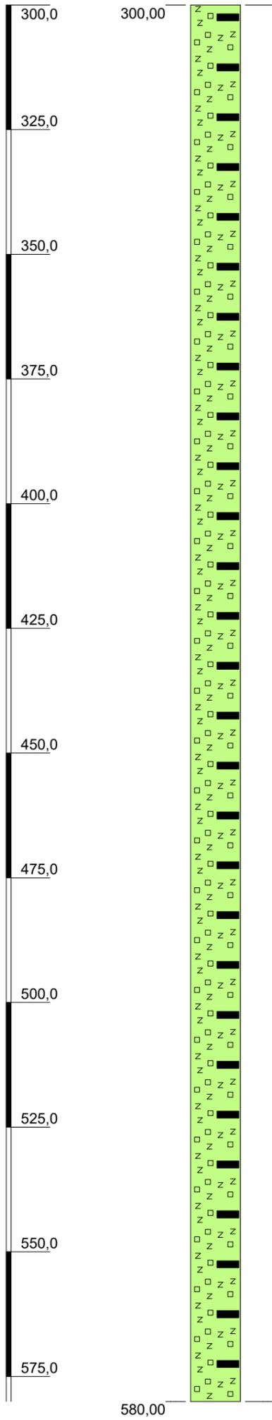
Zechstein, Steinsalz (schwach bituminös, grobkristallin, Kieserit (Schichtbereich 590m bis 622,4m)), Salz (Kristalle, groß)
